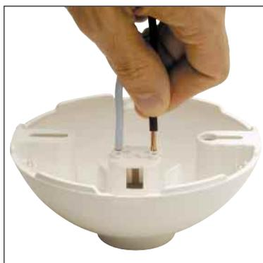
2. Colocar el cable en el borne y empujarlo
